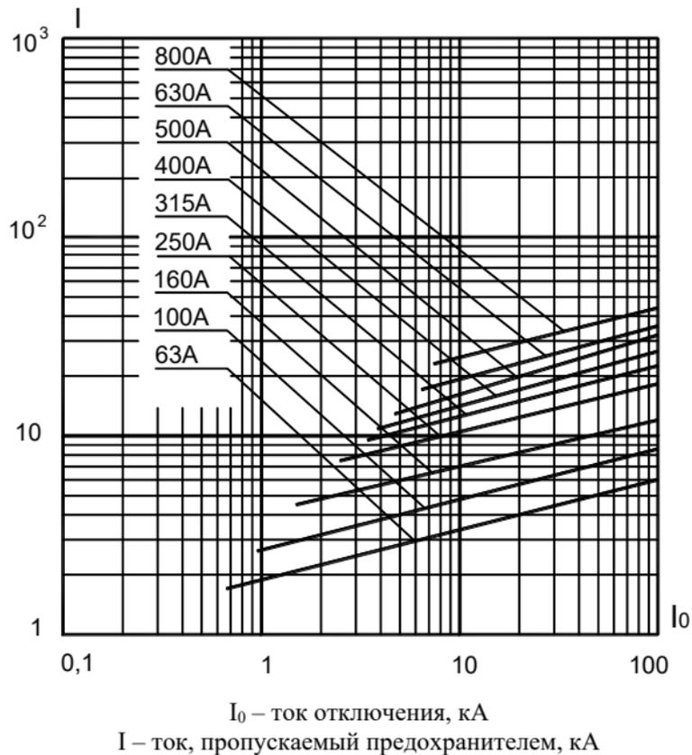
Рисунок В.16 – Предохранители типа ПП57-3797, ПП57-3997, ПП57-3998К, ПП57-3998
