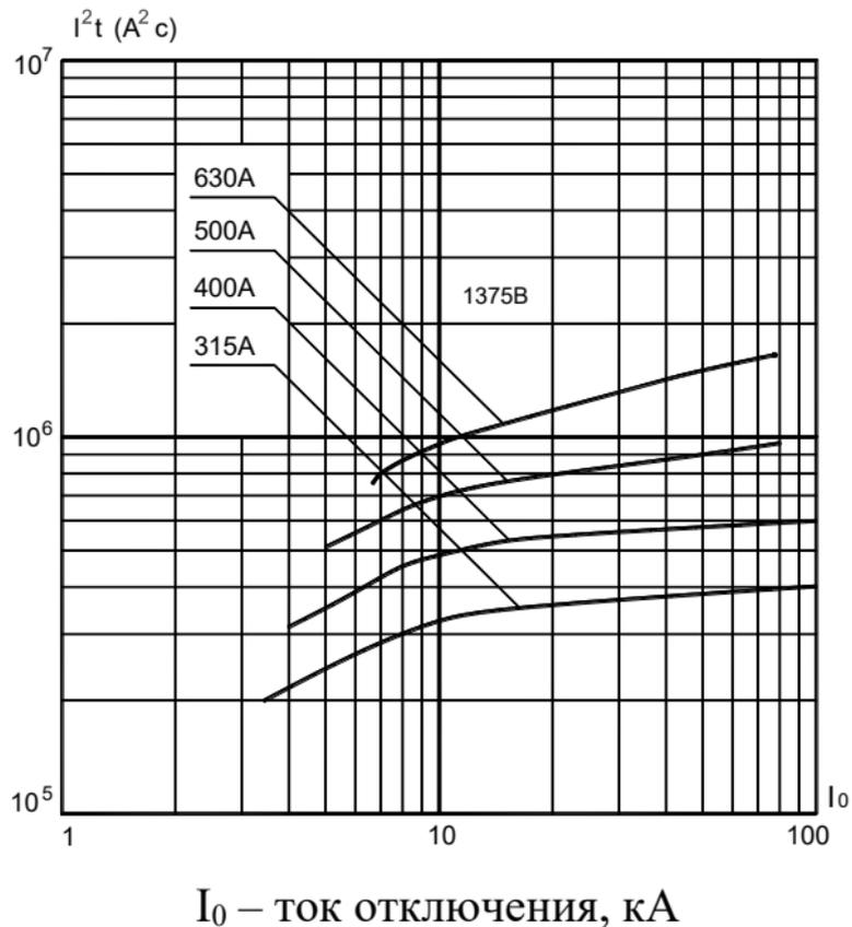
Рисунок В.13 – Предохранители типа ПП57-3427
