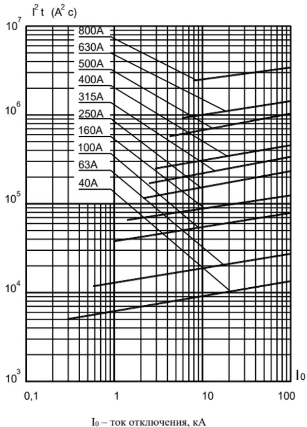
Рисунок В.11 – Предохранители типа ПП57-3167, ПП57-3467, ПП57-3767, ПП57-3967, ПП57-3768, ПП57-3968, ПП57-4068, ПП57-3968Б
