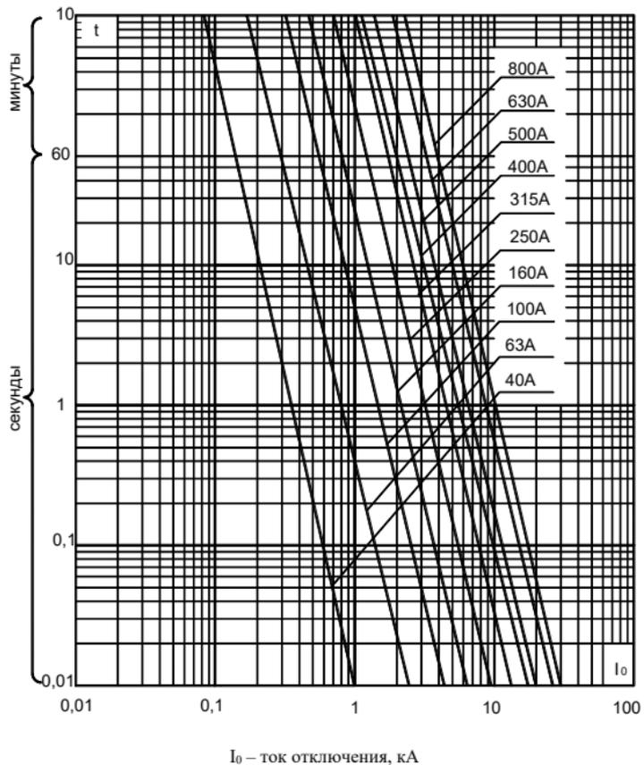
Рисунок В.7 – Предохранители типа ПП57-3167, ПП57-3467, ПП57-3767, ПП57-3967, ПП57-3768, ПП57-3968, ПП57-4068, ПП57-3968Б
