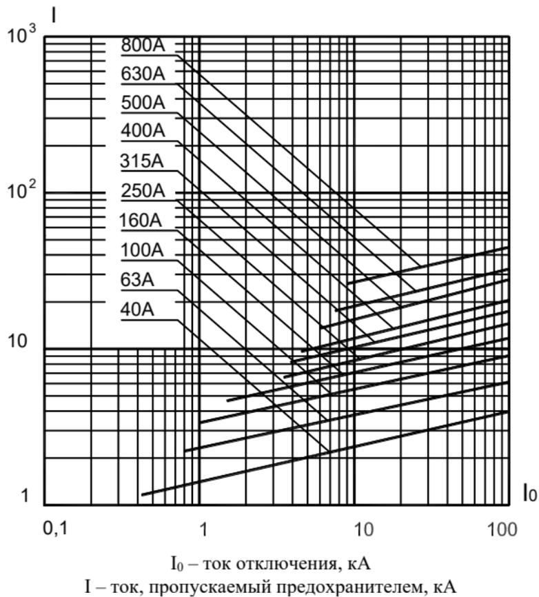
Рисунок В.15 – Предохранители типа ПП57-3167, ПП57-3467, ПП57-3767, ПП57-3967, ПП57-3768, ПП57-3968, ПП57-4068, ПП57-3968Б
