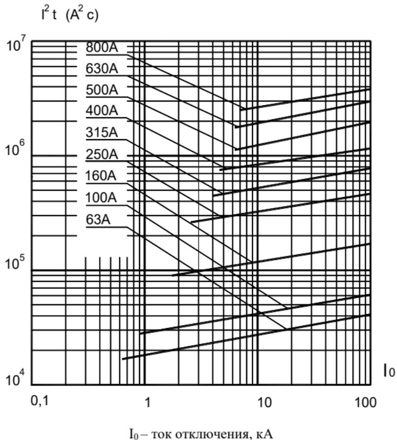
Рисунок В.12 – Предохранители типа ПП57-3797, ПП57-3997, ПП57-3998К, ПП57-3998
