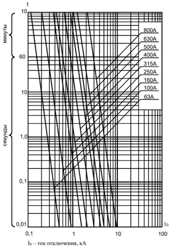
Рисунок В.4 – Предохранители типа ПП57-3797, ПП57-3997, ПП57-3998К, ПП57-3998
