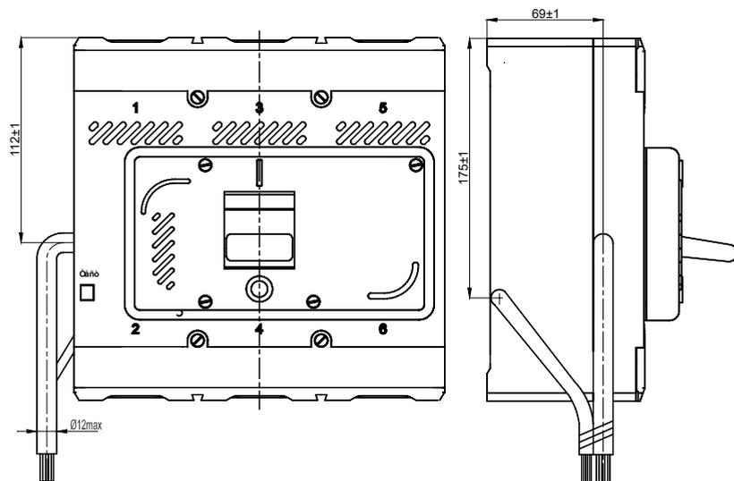
Масса ручного дистанционного привода для оперирования через дверь распределительного устройства – 0,51 кг.
