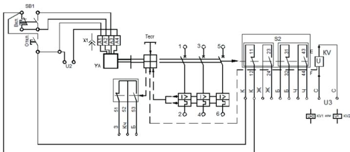
**Рисунок В.6** – Схема электрическая принципиальная выключателей выдвигного исполнения, с независимым расцепителем, вспомогательными контактами, вспомогательными контактами сигнализации автоматического отключения и электромагнитным приводом
