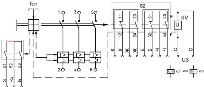
**Рисунок В.5** – Выключатель с нулевым или минимальным расцепителем напряжения, вспомогательными контактами сигнализации автоматического отключения, вспомогательными контактами и электромагнитным приводом
