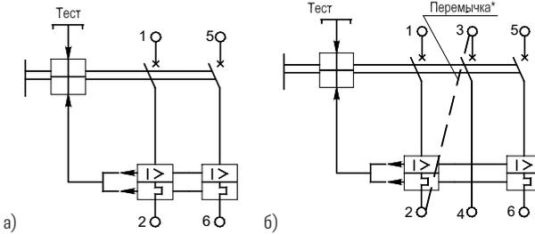
**Рисунок В.3** – Выключатель с независимым расцепителем и вспомогательными контактами
