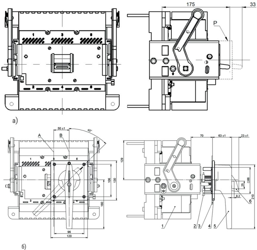
**Рисунок Б.8** – Выключатель выдвижного исполнения с электромагнитным приводом:
