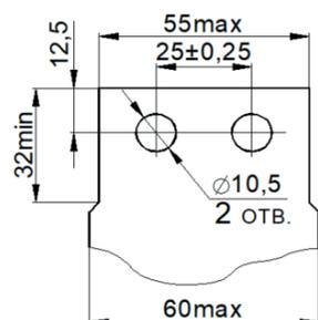
Рисунок Д.3 – Присоединение с переходной шиной
