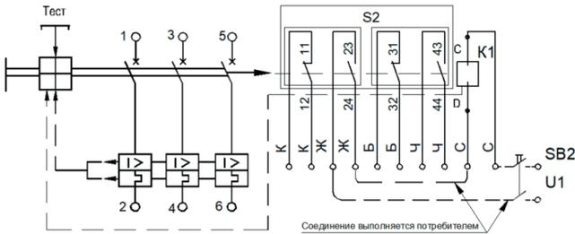
Кнопочный выключатель SB2 независимого расцепителя K1 может быть с двойным или одинарным разрывом цепи. Монтаж электрических цепей, указанных на рисунке штрих-пунктиром, установка кнопочного выключателя SB2 осуществляется потребителем.
