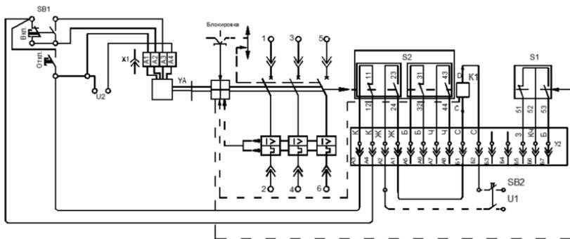
**Рисунок В.7** – Электрическая принципиальная схема привода электромагнитного
