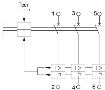
**Рисунок В.1 – Выключатель переменного тока трехполюсного исполнения**
