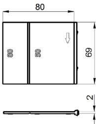
**Рисунок Б.4 – Габаритные размеры межполюсных перегородок**
