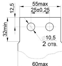
**Рисунок Д.2** – Форма и размеры присоединяемой шины максимального
