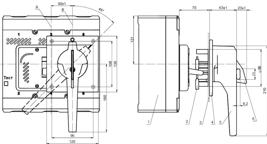
**Рисунок Б.3 – Выключатель с ручным дистанционным приводом для оперирования через дверь распределительного устройства:** А – вертикальная ось выключателя, В – вертикальная ось ручного дистанционного привода.
