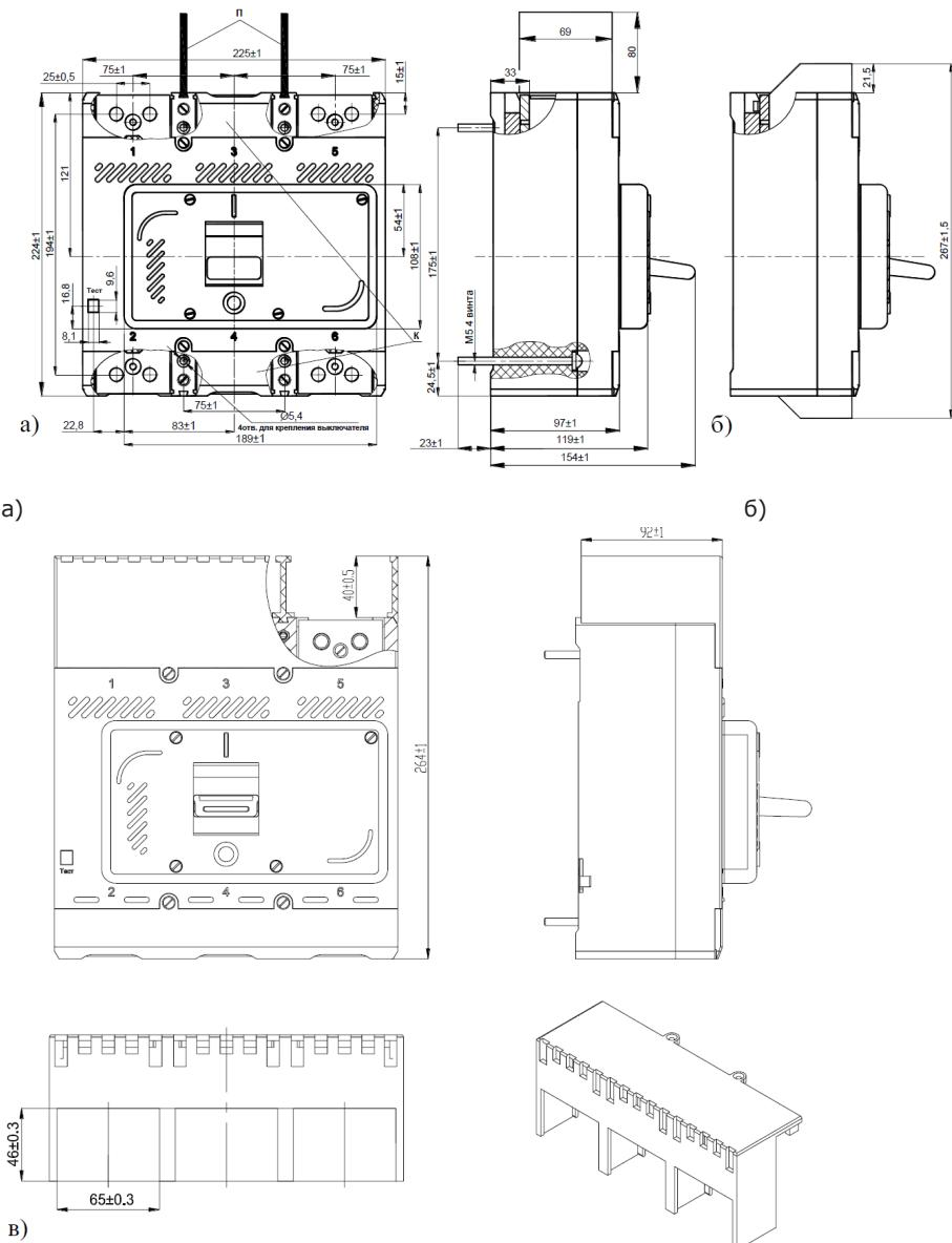
**Рисунок Б.1 – Выключатель стационарного исполнения с зажимами для переднего присоединения:** а) выключатель с зажимами №3;
