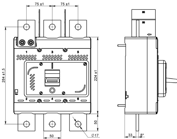
**Рисунок Д.3 – Присоединение к удлинительному выводу**
