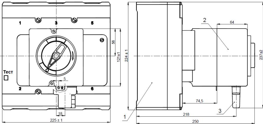
**Рисунок Б.2 – Выключатель с электромагнитным приводом:**
