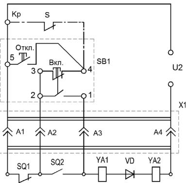
**Рисунок В.7 – Электрическая принципиальная схема привода электромагнитного**
