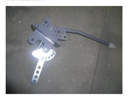
На корпусе привода предусмотрены два положения установки сектора. На секторе имеются отверстия для регулировки положения привода относительно выключателя.
