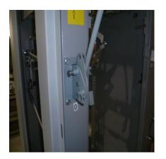
Установка сектора рычага и соединение тягой в сборе с приводом
