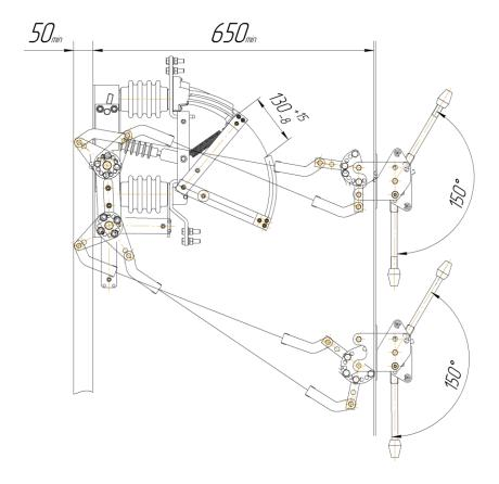
Рис.1 Возможное расположение ВНА с приводом ПР-10. Промежуточные тяги (показаны тонкой линией) в комплект поставки не входят.
