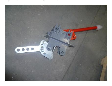
Для сочленения привода и выключателя понадобится тяга. Тяга состоит из шпильки, определенного размера, с резьбой М16 и длиной резьбы не менее 50 мм., и вилок показанных на фото ниже.
