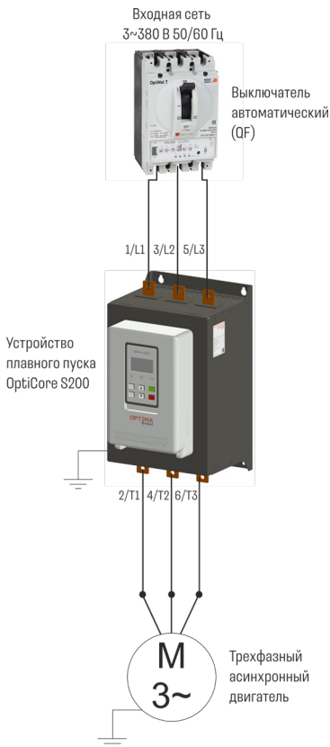
Рисунок 2.5 – Схема подключения силовых цепей УПП со встроенным байпасным контактором
