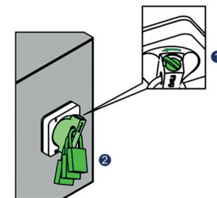
Рисунок 7 – Блокировка выключателя в положении «Отключено» OptiMat D100, D160, D250
