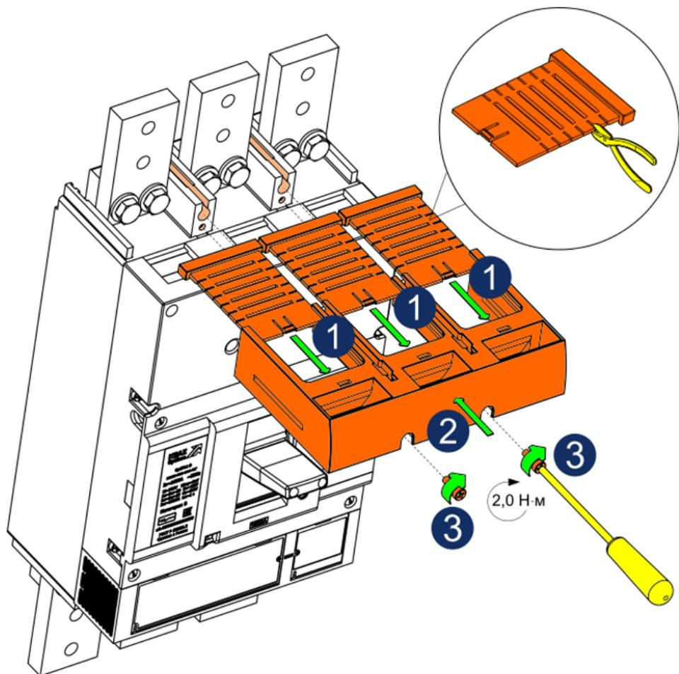
Клеммные крышки аналогично устанавливаются на верхние и нижние выводы как на стационарное, так и на выдвижное исполнение выключателя.
