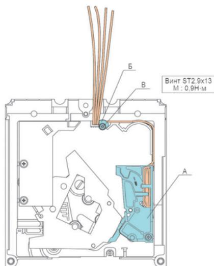
**Рисунок 2** – Установка контактов опережающего действия в привод ручной дистанционный OptiMat D400, D630
