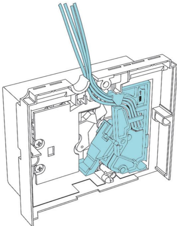
**Рисунок 1** – Установка контактов опережающего действия в привод ручной дистанционный OptiMat D100, D160, D250
