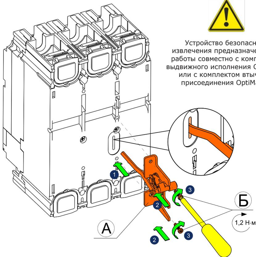
**Рисунок 1** - Установка устройства безопасного извлечения
