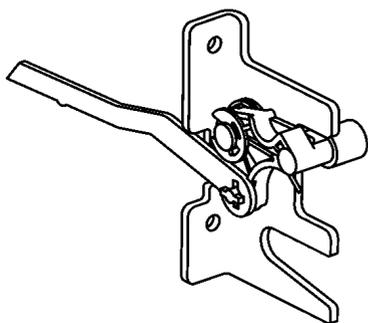
Устройство безопасного извлечения втычного и выдвжного исполнения выключателей OptiMat D400, D630
