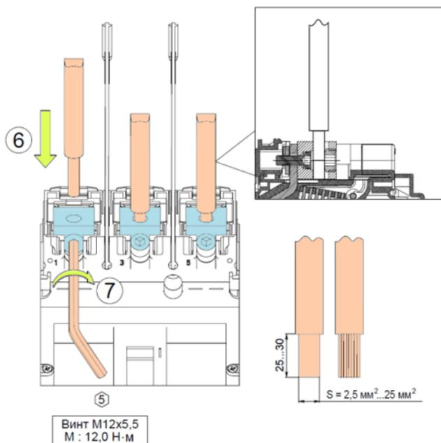
**Рисунок 2** – Установка зажимов для присоединения одного кабеля OptiMat D100, D160, D250 63-250 A.
