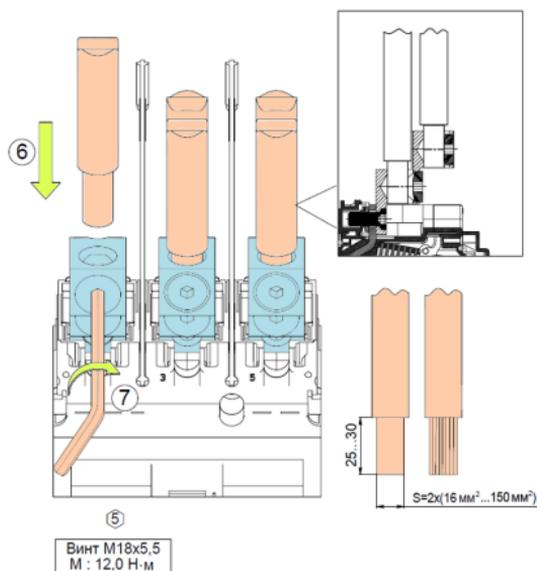
**Рисунок 4** – Подключение проводника вторичной цепи к зажимам для одного кабеля
