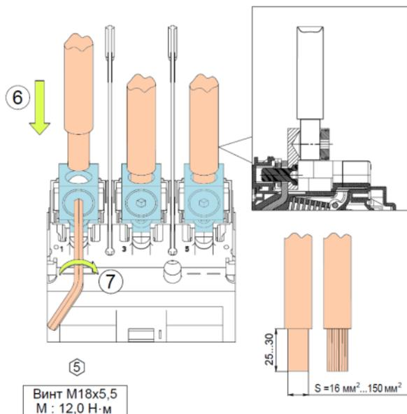
**Рисунок 3** – Установка зажимов для присоединения двух кабелей OptiMat D100, D160, D250 63-250 А.
