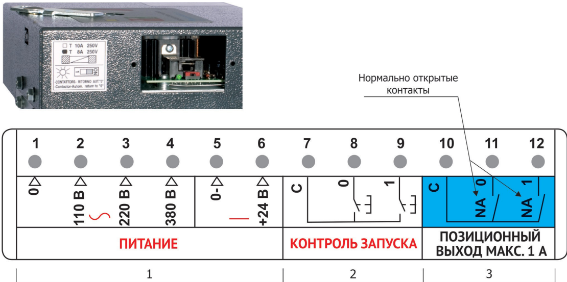
Рисунок 6 - Схема подключения мотор-привода реверсивных выключателей-разъединителей
