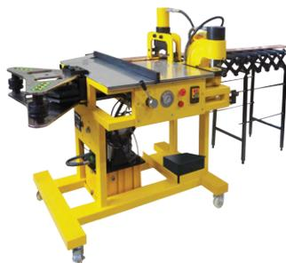
ДЛЯ ВЫПОЛНЕНИЯ ВСЕГО КОМПЛЕКСА РАБОТ ПО РЕЗКЕ И ГИБКЕ ТОКОВЕДУЩЕЙ ШИНЫ, ПРОБИТИЮ ОТВЕРСТИЙ, ВДАВЛИВАНИЮ ГАЕК
