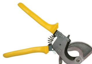
Ножницы секторные НС-32М предназначены для резки многожильного медного и алюминиевого небронированного кабеля максимальным диаметром до 32 мм. Не режет сталь и стальной трос. Вес 0.6 кг.
