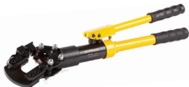
Ножницы гидравлические НГ-40С предназначены для резки провода А и АС диаметром до 40 мм и стального троса диаметром до 20 мм. Откидная головная часть позволяет заводить ножницы на кабель в любом месте. Вес 3.3 кг.
