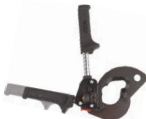
Ножницы секторные НС-45 предназначены для резки многожильного медного и алюминиевого небронированного кабеля максимальным диаметром до 45 мм. Не режет сталь и стальной трос. Вес 1 кг.
