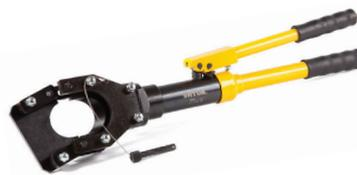
Ножницы гидравлические НГ-52Б предназначены для резки медного и алюминиевого кабеля (в том числе бронированного) диаметром до 45 мм и телефонного кабеля Ø до 50 мм. Вес 7.1 кг.
