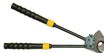
Ножницы секторные НС-14С предназначены для резки А и АС провода диаметром до 30 мм, стального троса диаметром до 11 мм и стальной цепи из низкоуглеродистой стали. Не режет медный и алюминиевый кабель. Вес 1.97 кг.
