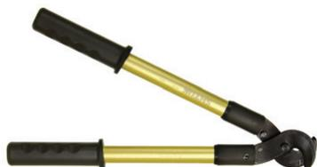
Ножницы кабельные НК-25 предназначены для резки алюминиевого и медного небронированного кабеля максимальным диаметром до 30 мм. Трубчатые рукоятки. Не режет сталь и стальной трос. Вес 0.3 кг.
