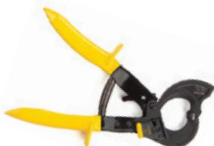
Ножницы секторные НС-32 предназначены для резки многожильного медного и алюминиевого легкобронированного кабеля максимальным диаметром до 32 мм. Не режет сталь и стальной трос. Вес 0.6 кг.
