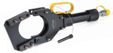
Насадка гидравлическая НГ-100+ предназначена для резки телефонного и небронированного кабеля диаметром до 100 мм; бронированного Cu и Al кабеля диаметром до 75 мм. Требуется подключение насоса. Вес 8.4 кг.
