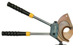
Ножницы секторные НС-100БС предназначены для резки многожильного бронированного медного и алюминиевого кабеля с максимальным диаметром до 100 мм. Не режет сталь и стальной трос. Вес 4.2 кг.
