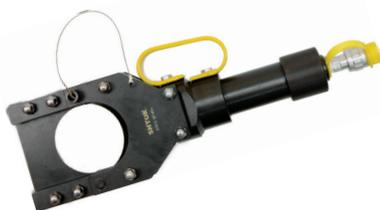
Насадка гидравлическая НГ-85+ предназначена для резки телефонного и небронированного кабеля диаметром 85 мм; бронированного Cu и Al кабеля диаметром до 50 мм. Требуется подключение насоса. Вес 7.9 кг.
