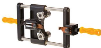
Устройство СИ-150 предназначено для снятия с силовых кабелей диаметром от 90 до 150 мм оболочки и основной изоляции из сшитого полиэтилена. Запасные лезвия в комплекте.
