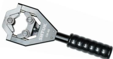
Устройство СИ-40 для снятия изоляции с силовых кабелей, защитной оболочки и основной изоляции из сшитого полиэтилена диаметром от 20 до 40 мм. В комплекте 2 сменных ножа для снятия неотделяемого полупроводящего слоя и для снятия изоляции из сшитого полиэтилена.
