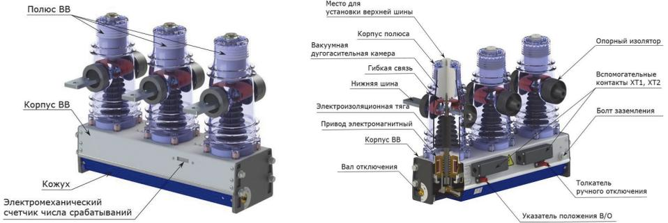
1.4.3 К неподвижному контакту ВДК жестко крепится верхняя шина (при необходимости) болтом М10 с усилием не более 30 Н. К подвижному контакту ВДК через гибкую связь крепится нижняя шина и электроизоляционная тяга, механически связанная с электромагнитным приводом с магнитной защелкой.
