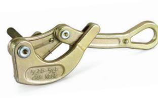
Применяется при регулировании стрелы провеса и подвески при монтаже защищенных и неизолированных проводов. Легко монтируется и демонтируется. Диаметр кабеля 4-22. Вес 1.4 кг.
