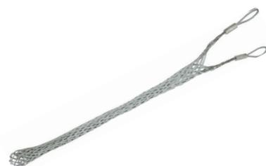
Предназначен для раскатки проводов СИП с удвоенным тяговым усилием. С двумя проушинами. Наружный диаметр СИП 90-115 мм. Рабочая нагрузка при натяжении 2500 кг.
