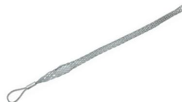
Предназначен для раскатки проводов СИП на опорах. Наружный диаметр СИП 32-37 мм. Рабочая длина 406 мм. Рабочая нагрузка при натяжении 1810 кг.
