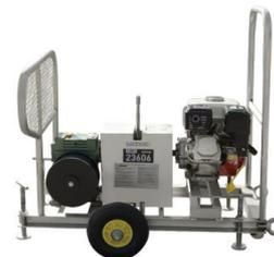
Предназначена для раскатки СИП. Рым-болты для дополнительной фиксации. Защитная решетка. Колеса для удобства перемещения. Двигатель «Хонда». Вес 40 кг.
