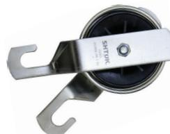
Используют на прямых участках линии и при малых углах до 30°. Катушка изготовлена из стеклонаполненных полиамидов. Раздвигающийся (вращающийся) крюк. Ширина желоба 50 мм. Вес 1.5 кг.
