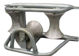
Ролик кабельно-угловой РКУ-55. Алюминиевый ролик и рама выполнены из цельной гнутой трубы с гальваническим цинковым покрытием и с закрытым шариковым подшипником. Высота 290 мм, ширина 215 мм, длина 600 мм. Максимальный внешний диаметр кабеля 140 мм. Вес 12 кг.
