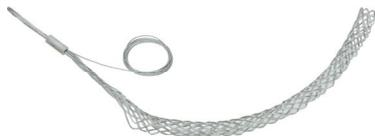
Предназначен для раскатки проводов СИП на опорах. Открытый. Наружный диаметр СИП 18-25 мм. Рабочая длина 305 мм. Рабочая нагрузка при натяжении 1130 кг.
