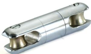
Предназначен для предотвращения образования петель провода СИП при его раскатке. Устанавливается между монтажным чулком и тросом-лидером. Диаметр 36.9 мм. Вес 0.75 кг.
