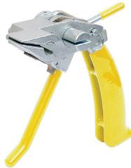
Инструмент для натяжения и резки стальной ленты с храповым механизмом и переставной рукояткой (для работы одной и двумя руками) предназначен для крепления кронштейнов, крюков и т.д. с помощью стальной ленты шириной до 20 и толщиной до 1.0 мм.
