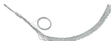
Предназначен для раскатки проводов СИП на опорах. Открытый. Наружный диаметр СИП 32-37 мм. Рабочая длина 406 мм. Рабочая нагрузка при натяжении 1810 кг.
