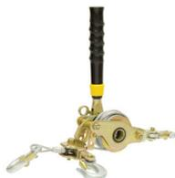
Предназначена для регулирования стрелы провиса при монтаже СИП. Усиленный корпус с антикоррозийным покрытием. Телескопическая ручка для уменьшения амплитуды. Возможность вращения ручки на 360°. Не применять для подъема/опускания грузов.
