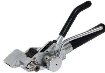
Инструмент для натяжения и резки стальной ленты с храповым механизмом предназначен для крепления кронштейнов, крюков и т.д. с помощью стальной ленты шириной до 20 и толщиной до 1.0 мм.
