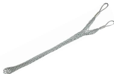
Предназначен для раскатки проводов СИП с удвоенным тяговым усилием. С двумя проушинами. Наружный диаметр СИП 60-75 мм. Рабочая нагрузка при натяжении 2000 кг.
