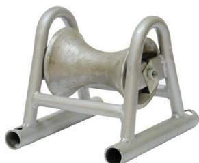
Ролик кабельно-линейный с боковыми дугами РКЛ-55. Алюминиевый ролик и рама выполнены из цельной гнутой трубы с гальваническим цинковым покрытием и с закрытым шариковым подшипником. Высота 225 мм, ширина 215 мм, длина 250 мм, максимальный внешний диаметр кабеля 140 мм. Вес 4.5 кг.
