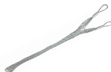
Предназначен для раскатки проводов СИП с удвоенным тяговым усилием. С двумя проушинами. Наружный диаметр СИП 75-90 мм. Рабочая нагрузка при натяжении 2500 кг.
