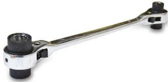
Ключ накидной трещоточный реверсивный. Ключ особенно удобен при монтаже и демонтаже прокалывающих зажимов линии СИП. Размеры головок 8, 10, 12, 13, 14, 17, 19, 21 мм.
