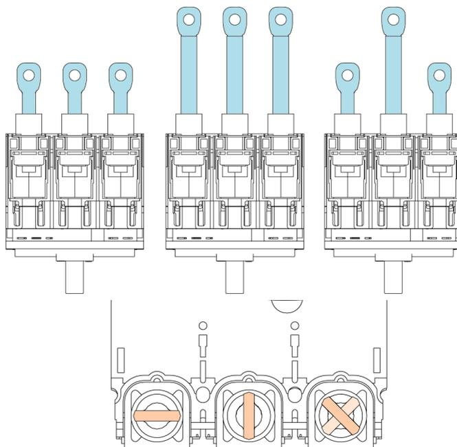
Рисунок 3 – Варианты установки выводов заднего присоединения на выключатель
