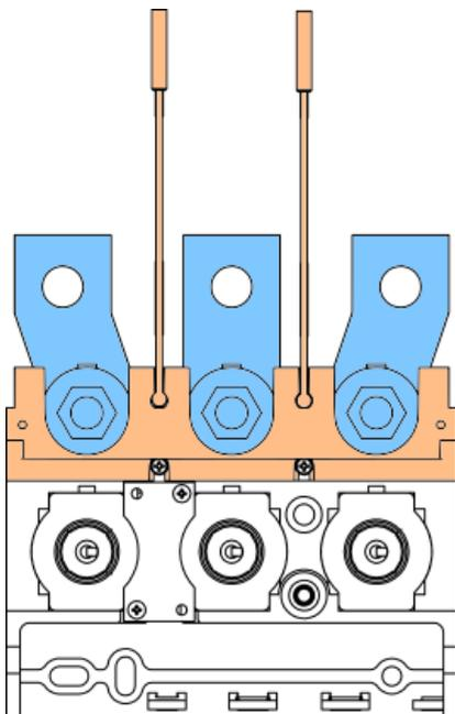
Рисунок 6 – Монтаж расширителей полюсов на фиксированную часть втычного и выдвжного исполнений выключателя OptiMat D400, D630 с межполюсными перегородками производится через адаптер для основания (адаптер для основания поставляется отдельно)
