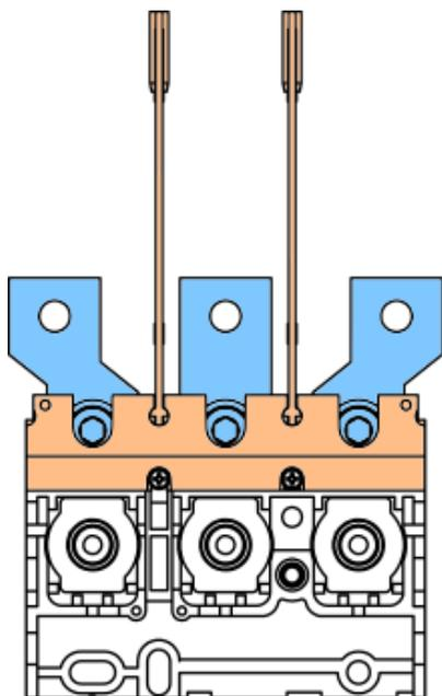
Рисунок 5 – Монтаж расширителей полюсов на фиксированную часть втычного и выдвжного исполнений выключателя OptiMat D100, D160, D250 с межполюсными перегородками производится через адаптер для основания (адаптер для основания поставляется отдельно)
