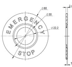
Рисунок А.14 – Бирка «Стоп» круглая 60 мм OptiSignal Compact D22 C7-MH2260
