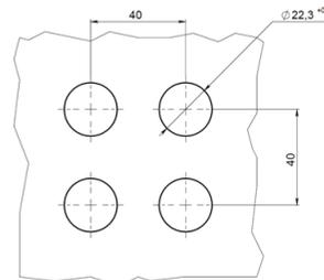
Рисунок 2 – Размеры установочных отверстий для цилиндрических выключателей
