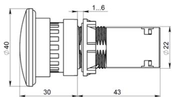
Рисунок А.3 – Выключатель OptiSignal Compact D22 C7-PM
