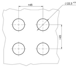
Рисунок 3 – Размеры установочных отверстий для грибовидных выключателей
