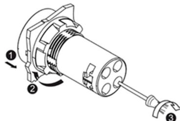
Рисунок 1 – Последовательность монтажа выключателей
