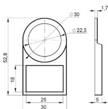
Рисунок А.13 – Держатель маркировки OptiSignal Compact D22 C7-MH2518
