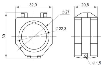
Рисунок А.9 – Защитный кожух OptiSignal Compact D22 C7-PC-P30
