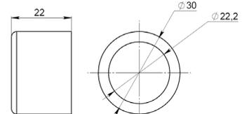
Рисунок А.6 – Колпачок защитный OptiSignal Compact D22 C7-BPA-2
