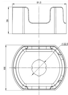
Рисунок А.8 – Защитный кожух OptiSignal Compact D22 C7-PC-ES60
