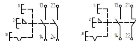
Выключатели с двумя замыкающими контактами
