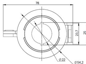
Рисунок А.10 – Крышка для опломбирования OptiSignal Compact D22 C7-SC-40
