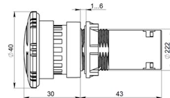
Рисунок А.4 – Выключатель OptiSignal Compact D22 C7-ESTR
