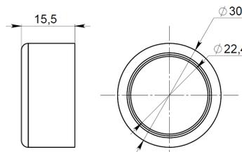
Рисунок А.5 – Колпачок защитный OptiSignal Compact D22 C7-BPA-1
