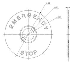
Рисунок А.15 – Бирка «Стоп» круглая 90 мм OptiSignal Compact D22 C7-MH2290
