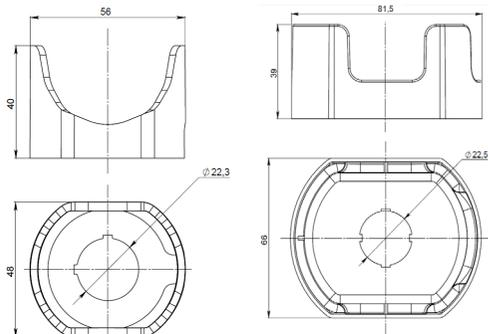
Рисунок А.7 – Защитный кожух OptiSignal Compact D22 C7-PC-ES40
