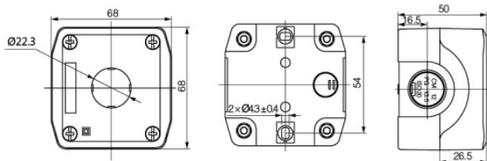
Рисунок А.1 – Корпус кнопочного поста OptiSignal Compact D22 C7-BD67-1
