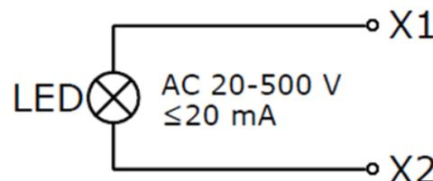
Рисунок Б.1 – Индикатор напряжения OptiSignal Compact D22 C7-VM
