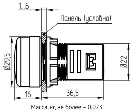
Рисунок А.1 – Индикатор напряжения OptiSignal Compact D22 C7-VM
