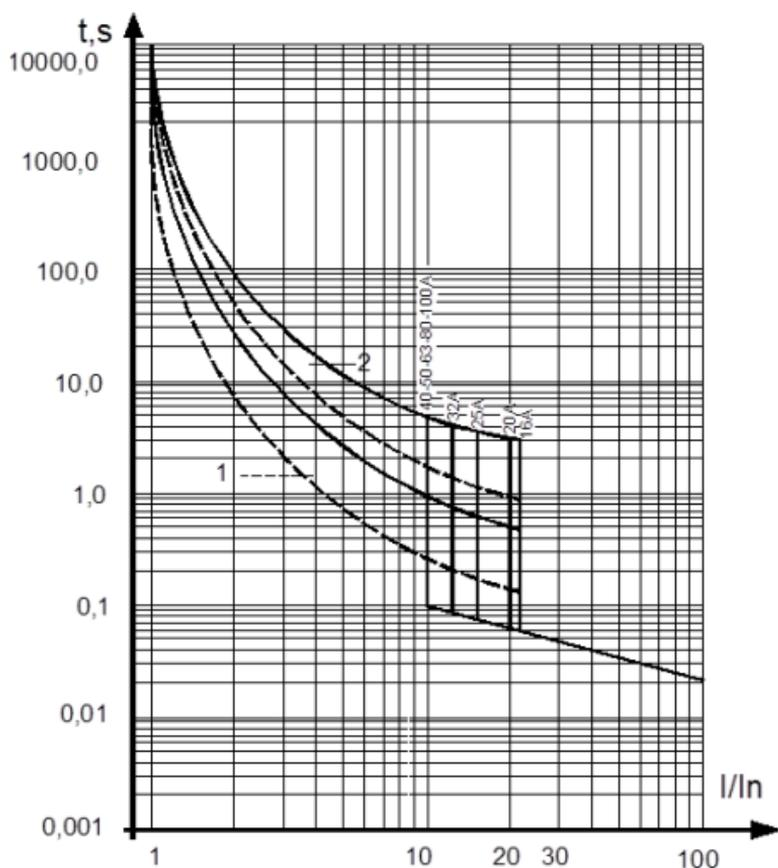
1 - зона работы теплового максимального расцепителя тока, снятая с нагретого состояния
