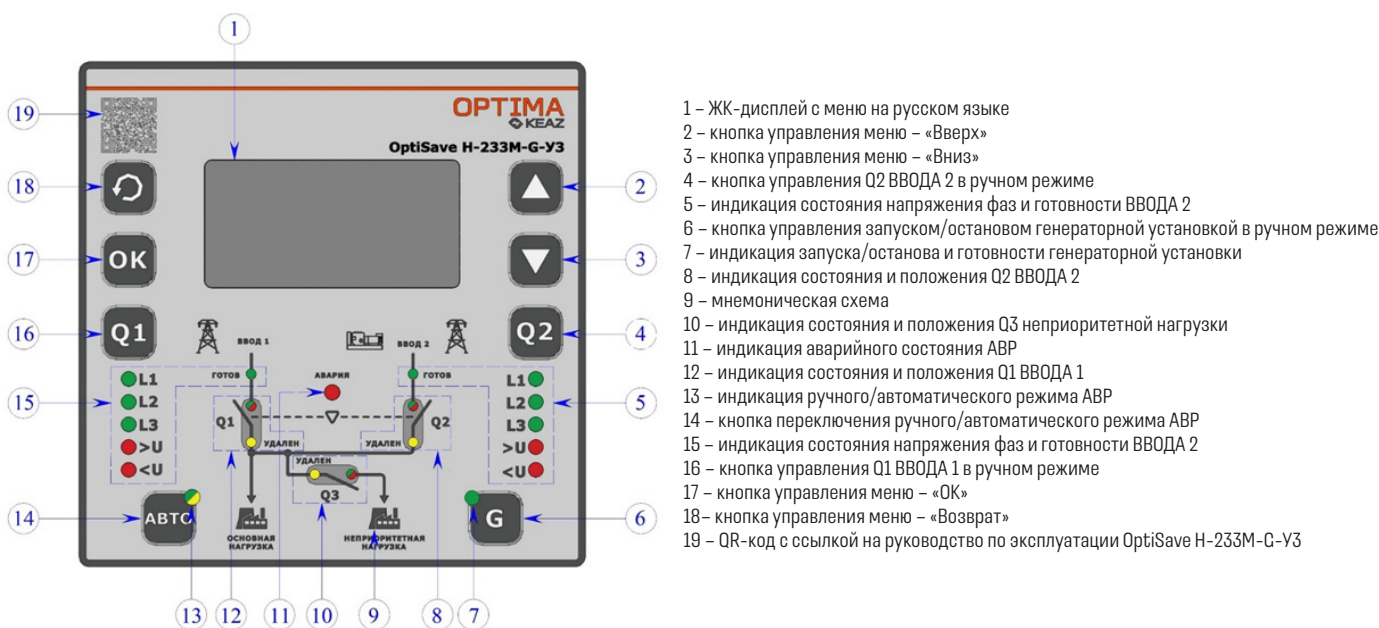
Рисунок 1 — Внешний вид лицевой панели OptiSave H-233M-G-Y3
