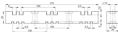
**Рисунок А.4** – Изолятор типа ИШП-270–3–5/Б, где Б – ширина паза для токоведущей шины толщиной 8 и 10 мм, А – диаметр отверстия 21 и 24,5 мм
