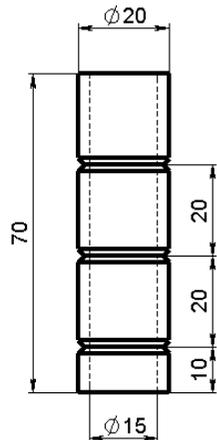
**Рисунок А.9** – Втулка изоляционная высокая L70 Optisol ИШП
