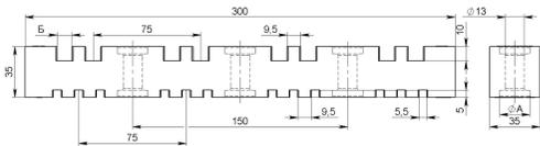
**Рисунок А.5** – Изолятор типа ИШП-300–4–5/Б, где Б – ширина паза для токоведущей шины толщиной 8 и 10 мм, А – диаметр отверстия 21 и 24,5 мм
