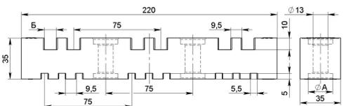
**Рисунок А.3** – Изолятор типа ИШП-220–3–5/Б, где Б – ширина паза для токоведущей шины толщиной 8 и 10 мм, А – диаметр отверстия 21 и 24,5 мм
