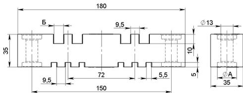
**Рисунок А.2** – Изолятор типа ИШП-180–2–5/Б, где Б – ширина паза для токоведущей шины толщиной 8 и 10 мм, А – диаметр отверстия 21 и 24,5 мм
