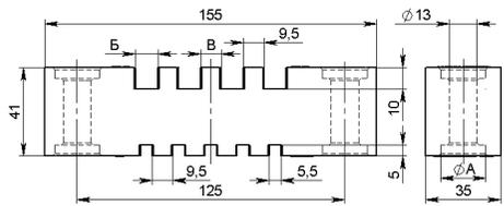
**Рисунок А.1** – Изолятор типа ИШП-155–1–5/Б, где Б – ширина паза для токоведущей шины толщиной 8 и 10 мм, А – диаметр отверстия 21 и 24,5 мм, В – ширина перемычки 9,5 и 13,5 мм
