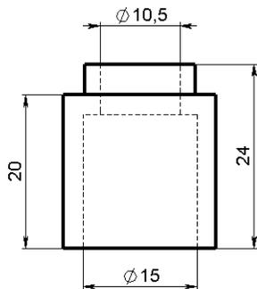
**Рисунок А.8** – Втулка изоляционная низкая L20 Optisol ИШП
