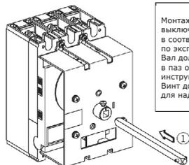
Монтаж автоматического выключателя осуществляется в соответствии с руководством по эксплуатации. Вал должен быть установлен в паз основания согласно данной инструкции до упора. Винт должен быть затянут для надежной фиксации вала.
