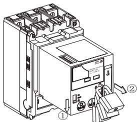
Переключатель «Auto/Manual» должен находиться в режиме «Заблокировано». Выключатель может быть заблокирован навесным замком, когда рычаг блокировки вытяннут (2). Заблокированный выключатель не может быть включен ручным или автоматическим способом. Замки в комплект поставки не входят.
