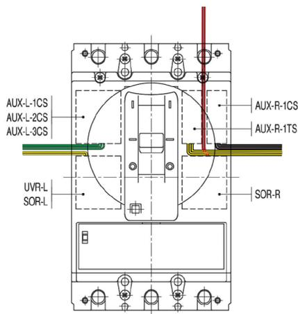
**Пример схемы расположения дополнительных единиц и вывода проводов для выключателей типоразмеров OptiMat T125-T160-T250-T400-T630 с электронными максимальными расцепителями тока (ETN, ETN-М, ЕТА, ЕТА-М, ЕТА-СОМ, ЕТА-М-СОМ, ЕТЕ, ЕТЕ-М)**
