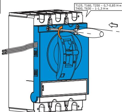
**Пример схемы расположения дополнительных аксессуаров и вывода проводов для выключателей OptiMat T125-T160-T250-T400-T630 с термомагнитными и электромагнитными расцепителями защиты (ТМ, ТМ-М, М, М-М)**
