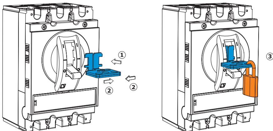
Установка устройства блокировки рукоятки в отключенном состоянии навесным замком
