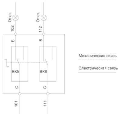
**в) контакты опережающего действия привода ручного дистанционного**
