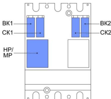
Функции, выполняемые вспомогательными контактами в зависимости от гнезда крышки, в которые они установлены:
