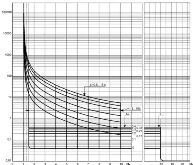
Время срабатывания выключателей при нагрузке каждого полюса в отдельности при различных уставках  $t_r$  приведено в таблице 7.
