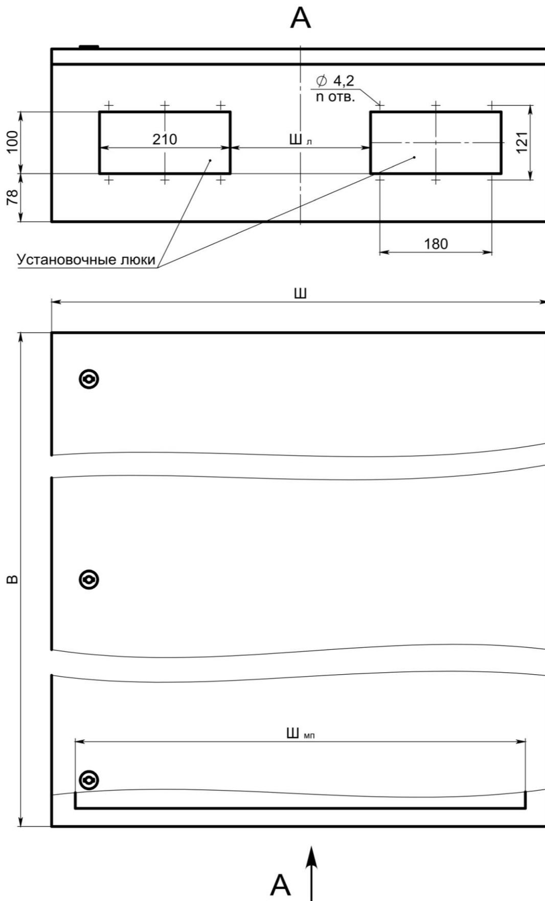
Рисунок 3 – Габаритные, установочные и присоединительные размеры корпусов ЩМП-СТД и ЩМП-ПРО высотой св. 900 мм включительно
