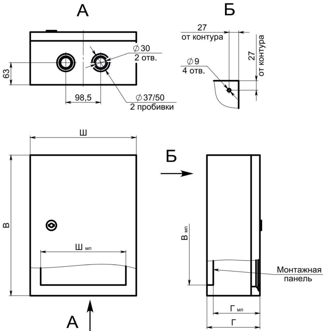
Рисунок 5 – Габаритные, установочные и присоединительные размеры корпусов ЩМП-ПРО высотой до 400 мм включительно
