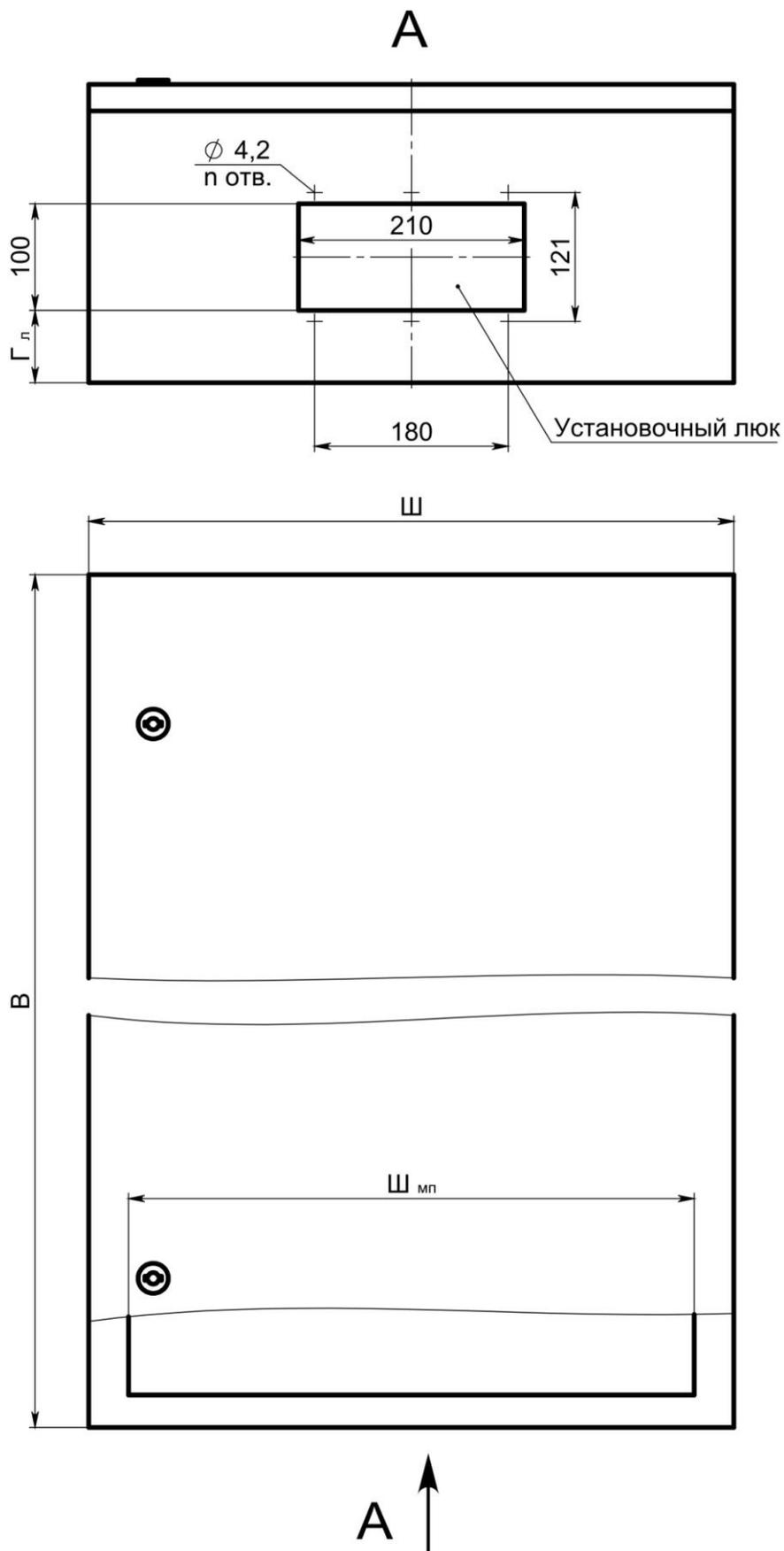
Рисунок 6 – Габаритные, установочные и присоединительные размеры корпусов ЩМП-ПРО высотой от 420 до 700 мм включительно
