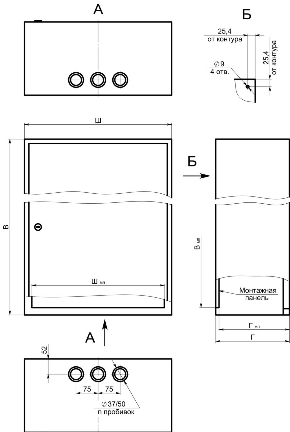
Рисунок 2 – Габаритные, установочные и присоединительные размеры корпусов ЩМП-СТД высотой до 800 мм включительно
