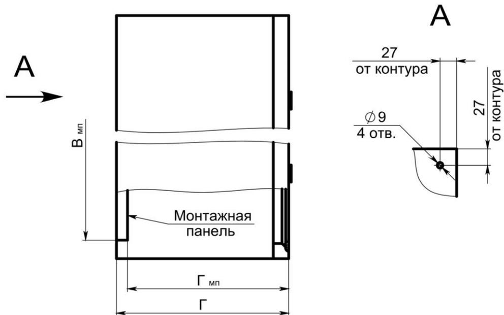
Рисунок 7 – Вид слева корпусов ЩМП-ПРО высотой от 420 до 700 мм включительно (остальное – см. рисунок 6)
