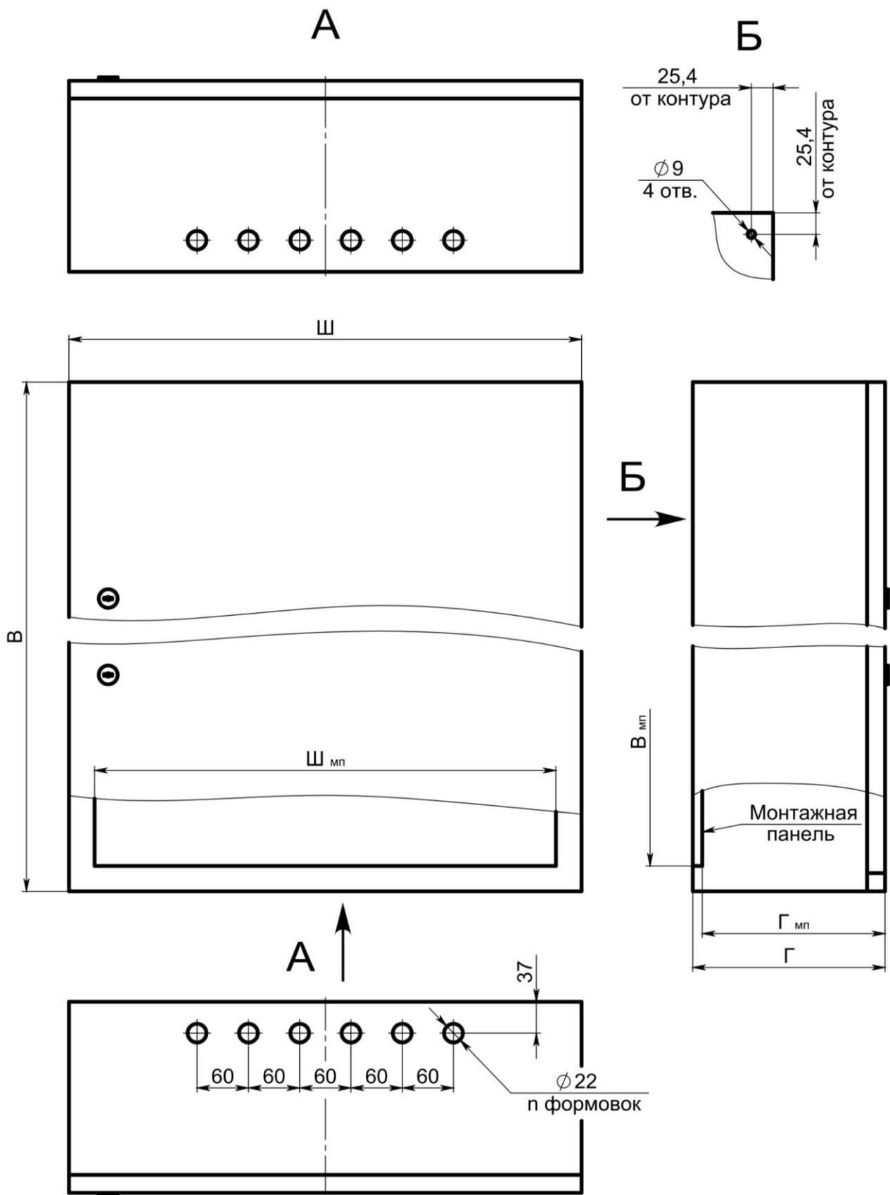
Рисунок 1 – Габаритные, установочные и присоединительные размеры корпусов ЩМП-КМП
