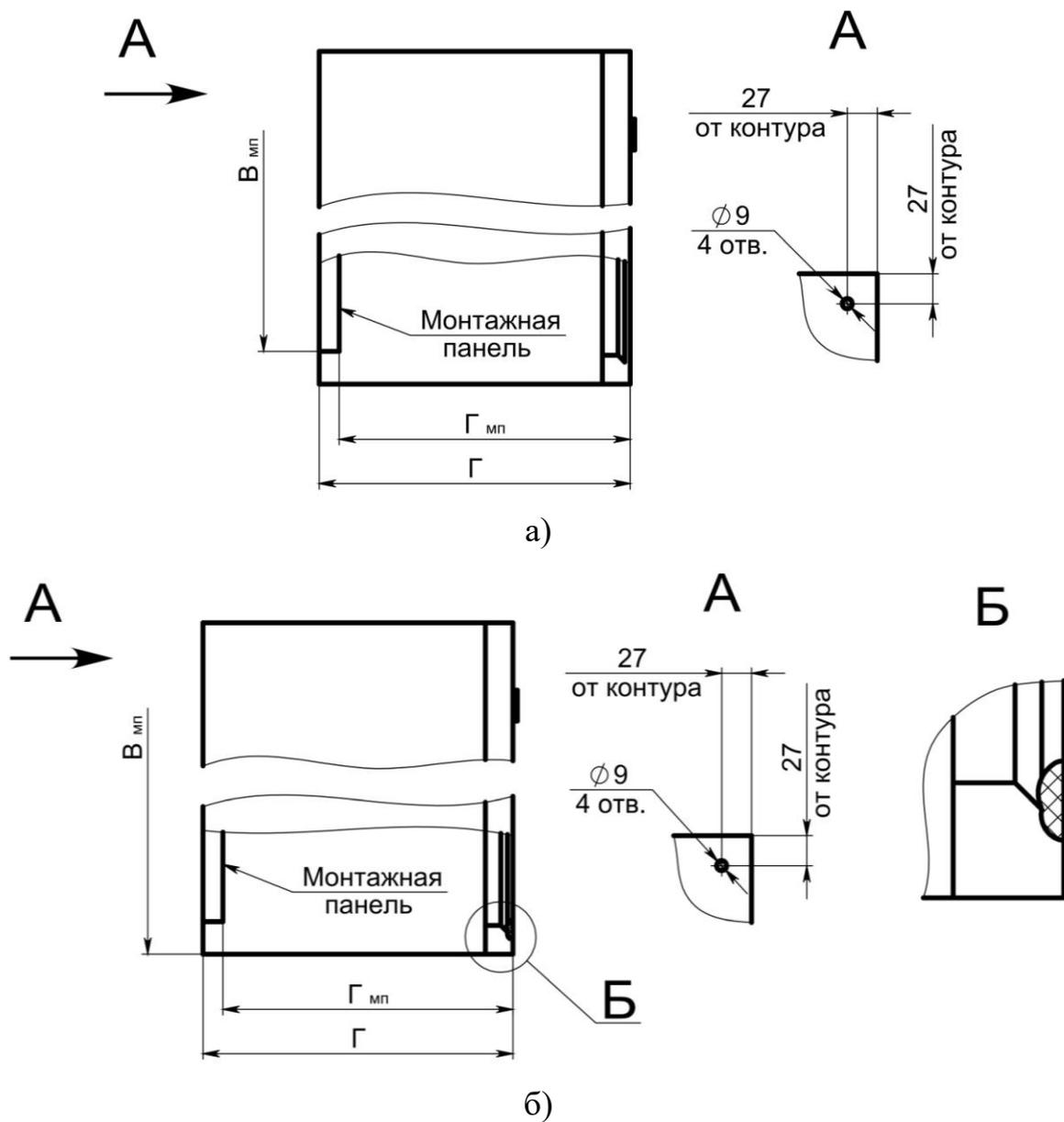
Рисунок 4 – Виды слева корпусов ЩМП-СТД и ЩМП-ПРО высотой св. 900 мм включительно (остальное – см. рисунок 3)
