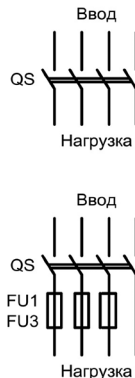
Рисунок А.3 – Схемы электрические принципиальные четырехполюсных ящиков ЯРП
