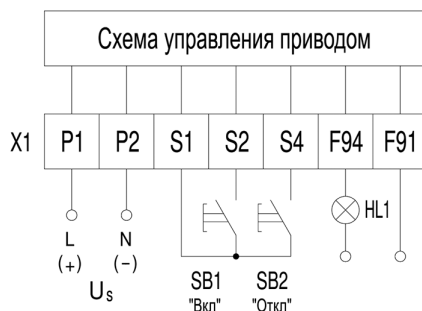
Рисунок 2 – Схема подключения привода
