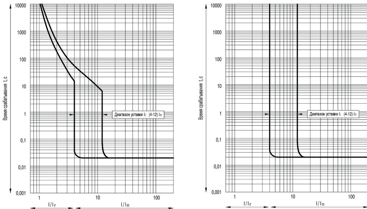
**Рисунок Б.10** — Время-токовые характеристики выключателей OptiMat T630 с термагнитными регулируемыми расцепителями типа ТМ-М для защиты электродвигателей и с электромагнитными регулируемыми расцепителями типа М-М для защиты электродвигателей.
