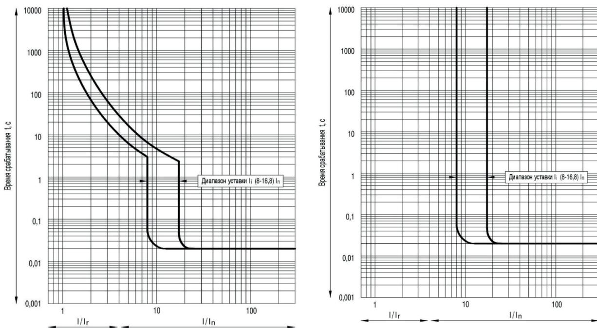
**Рисунок Б.5** — Время-токовые характеристики выключателей OptiMat T250 с термомангнитными регулируемыми расцепителями типа ТМ для защиты распределительных сетей и с электромагнитными регулируемыми расцепителями типа М для защиты распределительных сетей.
