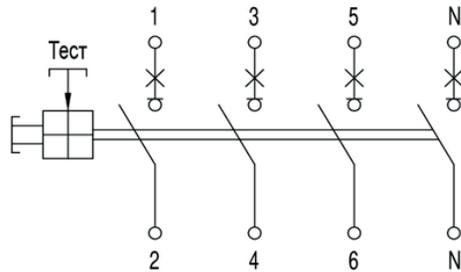
**Рисунок В.4** – Электрическая функциональная схема выключателей с защитой от токов утечки и терромагнитными расцепителями защиты
