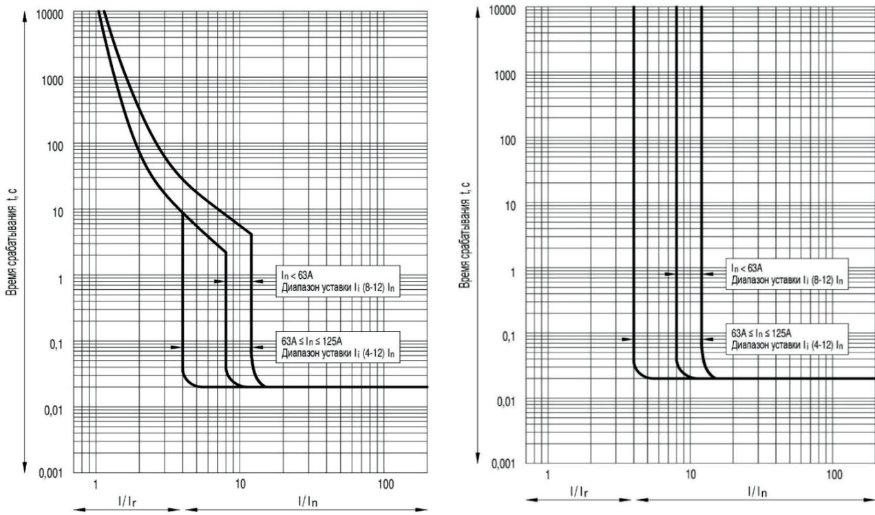
**Рисунок Б.2** — Время-токовые характеристики выключателей OptiMat T125 с термомангнитными регулируемыми расцепителями типа ТМ-М для защиты электродвигателей и с электромагнитными регулируемыми расцепителями типа М-М для защиты электродвигателей.
