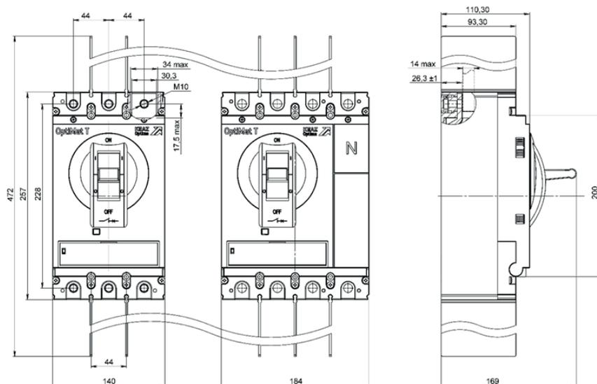
Рисунок 11 – Габаритные размеры выключателей OptiMat T125, T250, T400 (T630) с блоком защиты от токов утечки RC.
