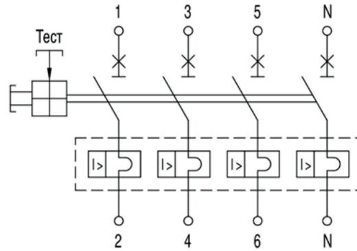
**Рисунок В.3** – Электрическая функциональная схема выключателей-разъединителей
