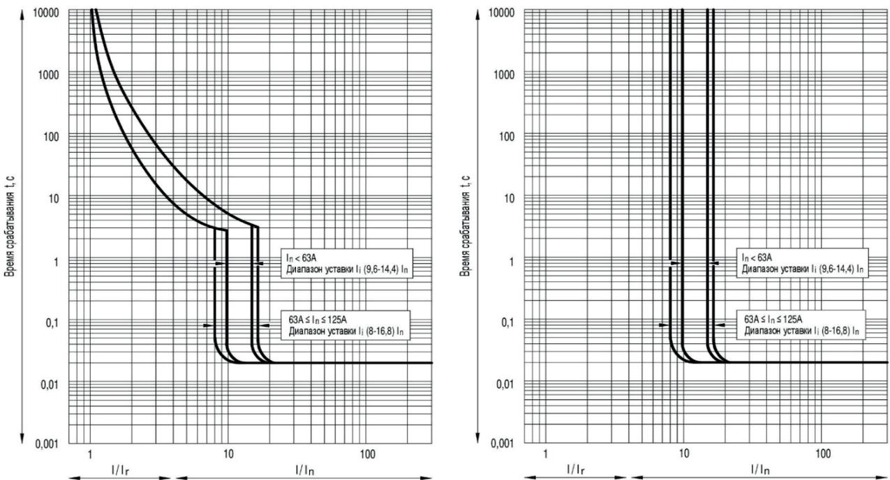
**Рисунок Б.3** — Время-токовые характеристики выключателей OptiMat T160 с терромагнитными регулируемыми расцепителями типа ТМ для защиты распределительных сетей и с электромагнитными регулируемыми расцепителями типа М для защиты распределительных сетей.
