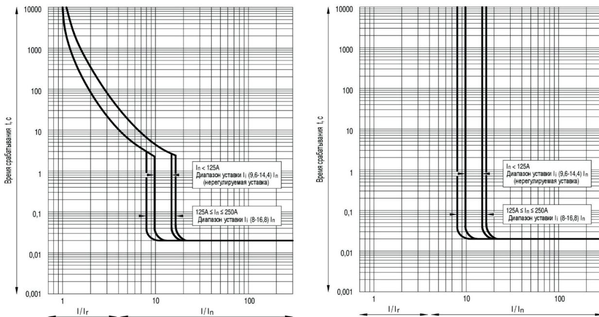
**Рисунок Б.7**— Время-токовые характеристики выключателей OptiMat T400 термомангнитными регулируемыми расцепителями типа ТМ для защиты распределительных сетей и с электромагнитными регулируемыми расцепителями типа М для защиты распределительных сетей.
