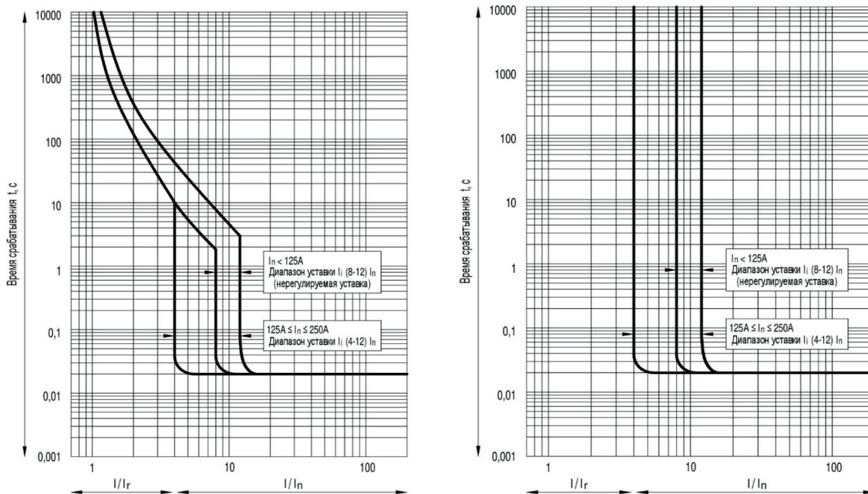
**Рисунок Б.6** — Время-токовые характеристики выключателей OptiMat T250 с термомангнитными регулируемыми расцепителями типа ТМ-М для защиты электродвигателей и с электромагнитными регулируемыми расцепителями типа М-М для защиты электродвигателей.
