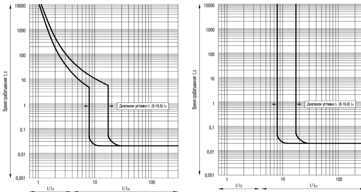
**Рисунок Б.9** — Время-токовые характеристики выключателей OptiMat T630 с термагнитными регулируемыми расцепителями типа ТМ для защиты распределительных сетей и с электромагнитными регулируемыми расцепителями типа М для защиты распределительных сетей.
