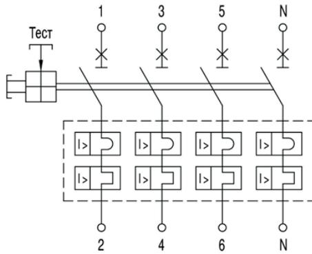
**Рисунок В.2** – Электрическая функциональная схема выключателей с электромагнитными расцепителями защиты
