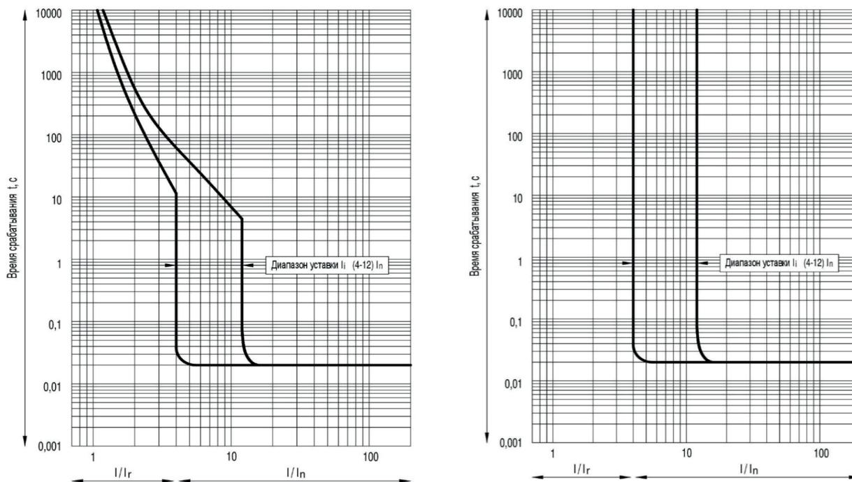
**Рисунок Б.8** — Время-токовые характеристики выключателей OptiMat T400 с термомангнитными регулируемыми расцепителями типа ТМ-М для защиты электродвигателей и с электромагнитными регулируемыми расцепителями типа М-М для защиты электродвигателей
