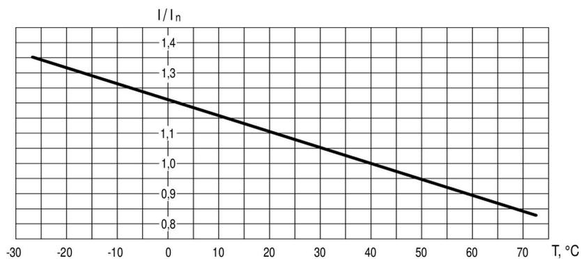
Рисунок 2 — Зависимость рабочего тока выключателей OptiMat T250 с термагнитными расцепителями типов ТМ и ТМ-М от температуры окружающей среды
