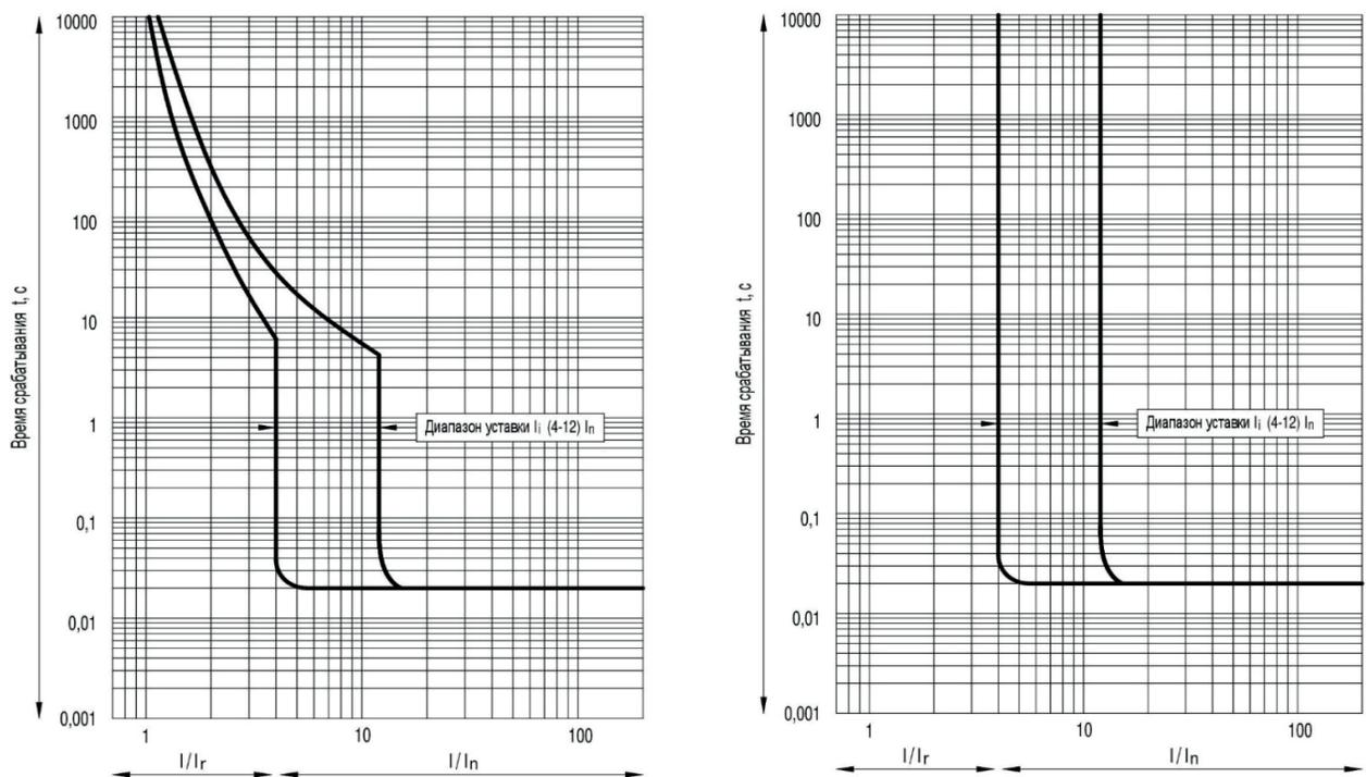
**Рисунок Б.4** — Время-токовые характеристики выключателей OptiMat T160 с терромагнитными регулируемыми расцепителями типа ТМ-М для защиты электродвигателей и с электромагнитными регулируемыми расцепителями типа М-М для защиты электродвигателей.
