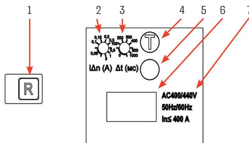
3.4 Выключатели-разъединители OptiMat T - SD предназначены для проведения тока в нормальном режиме и оперативных включений/отключений цепей под нагрузкой.
