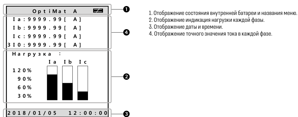
Рисунок 9 – Интерфейс главного экрана микропроцессорного расцепителя MR8.1
