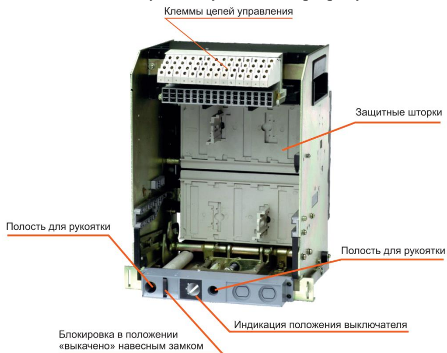
Рисунок 2 – Корзина выключателя OptiMat A-S1
