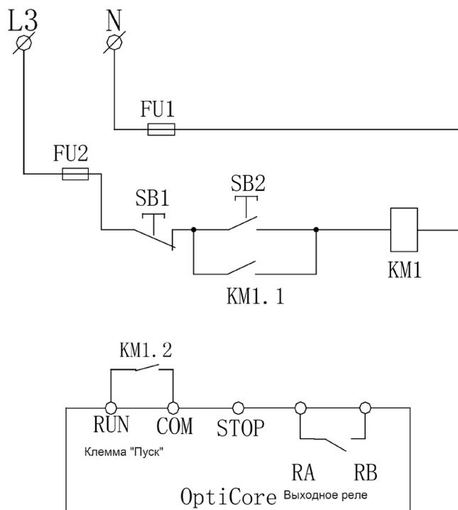
**Рисунок 4.4** - Двухпроводная цепь управления с линейным контактором
