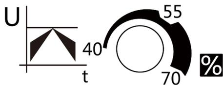
**Опорное напряжение:** используется для регулировки уровня напряжения в начале процесса плавного пуска. Диапазон настройки составляет от 40 % до 70 %. Уровень опорного напряжения зависит от типа нагрузки и силы трения приводного механизма в статическом состоянии. При увеличении уровня опорного напряжения, увеличивается пусковой крутящий момент. При настройке необходимо учитывать фактические данные по нагрузке и время пуска и останова, чтобы добиться наилучшего эффекта плавного пуска.
