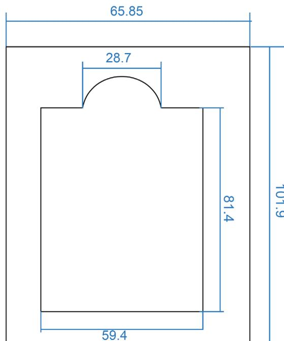
**Рисунок 6.2** - Установочные размеры
