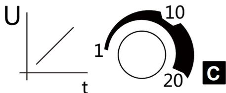
**Время пуска:** используется для настройки времени плавного пуска. Диапазон настройки составляет от 1 до 20 с. Чем дольше установлено время, тем более плавным будет процесс плавного пуска, что снижает механические и электрические перегрузки.
