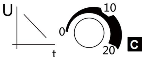
**Время останова:** используется для настройки времени плавной остановки. Диапазон настройки составляет от 0 до 20 с. Если время останова настроено на 0 с, то после подачи сигнала на останов, устройство плавного пуска мгновенно снимает напряжение с выходных цепей и начинается процесс останова электродвигателя выбегом.
