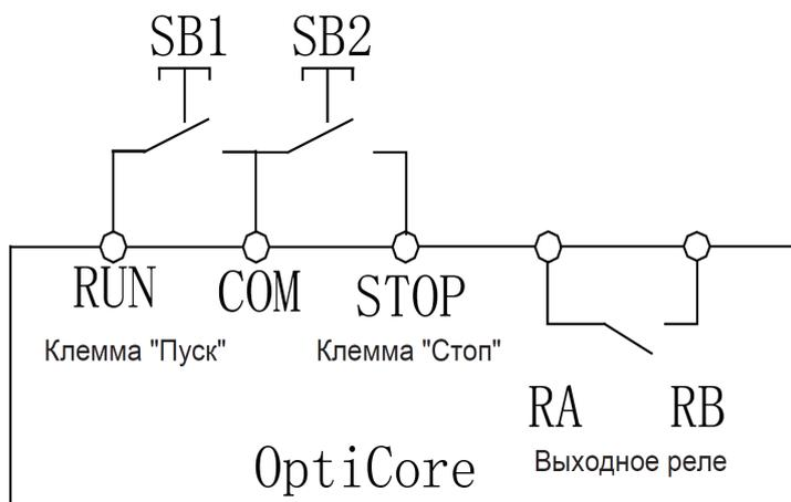
**Рисунок 4.3** - Трёхпроводная цепь управления
