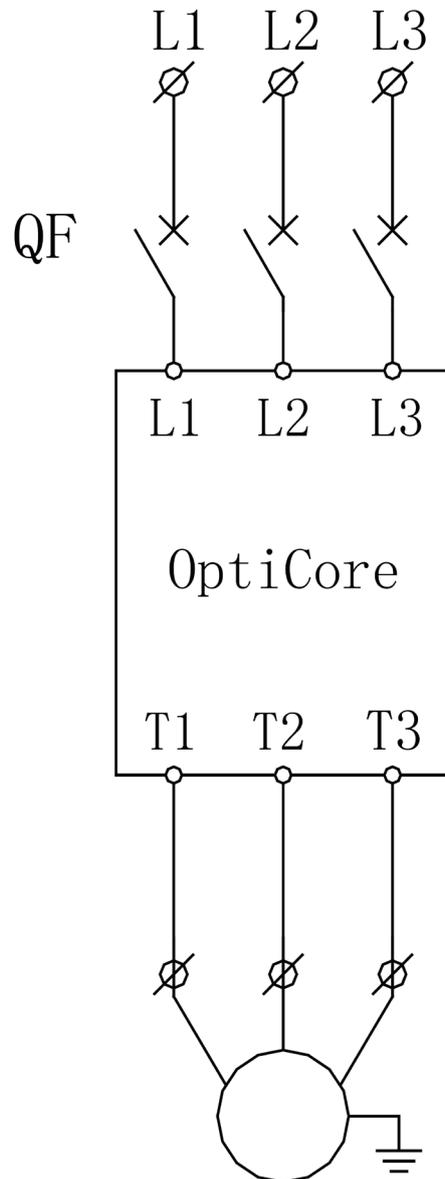
**Рисунок 4.1** - Схема подключения силовой части УПП
