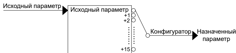
Рисунок 2.36 — Схема настройки параметров блоков переадресации
