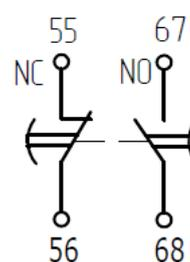
Рисунок Б.5 – Блок контактный с выдержкой времени типа LAETSD
