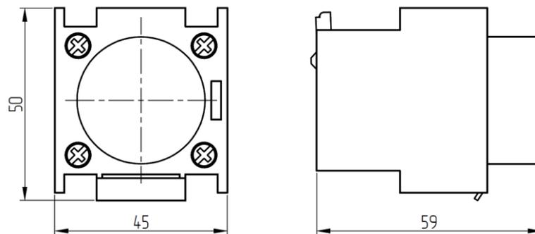
Рисунок А.3 – Блок контактный с выдержкой времени типа LAETSD
