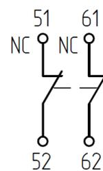
Рисунок Б.3 – Блок контактный типа LAEN02
