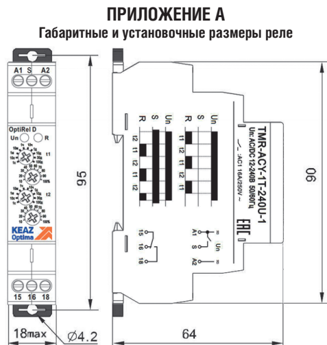
Рисунок А.1 – Габаритные и установочные размеры реле
