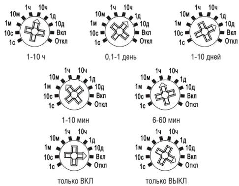
Рисунок 3.12 — Диапазоны выдержки реле
