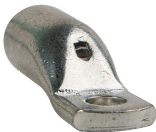
Наконечники силовые предназначены для оконцевания путем опрессовки предварительно зачищенных от изоляции алюминиевых и медных одножильных и многожильных проводов с номинальным сечением от 2,5 до 400 мм<sup>2</sup> и применяются для подключения оборудования с напряжением до 35кВ.
