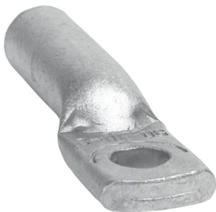
Наконечник кабельный алюмомедный OptiKit L-TAM используются для оконцевания одножильных и многожильных проводов с алюминиевыми жилами сечением от 16 до 240 мм<sup>2</sup> и применяются с последующим подключением их к медным шинам и клеммам электротехнических устройств с напряжением до 35 кВ.
