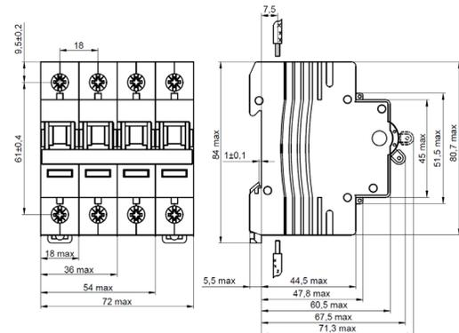
Рисунок Б.1 - Габаритные, установочные, присоединительные размеры выключателей.
