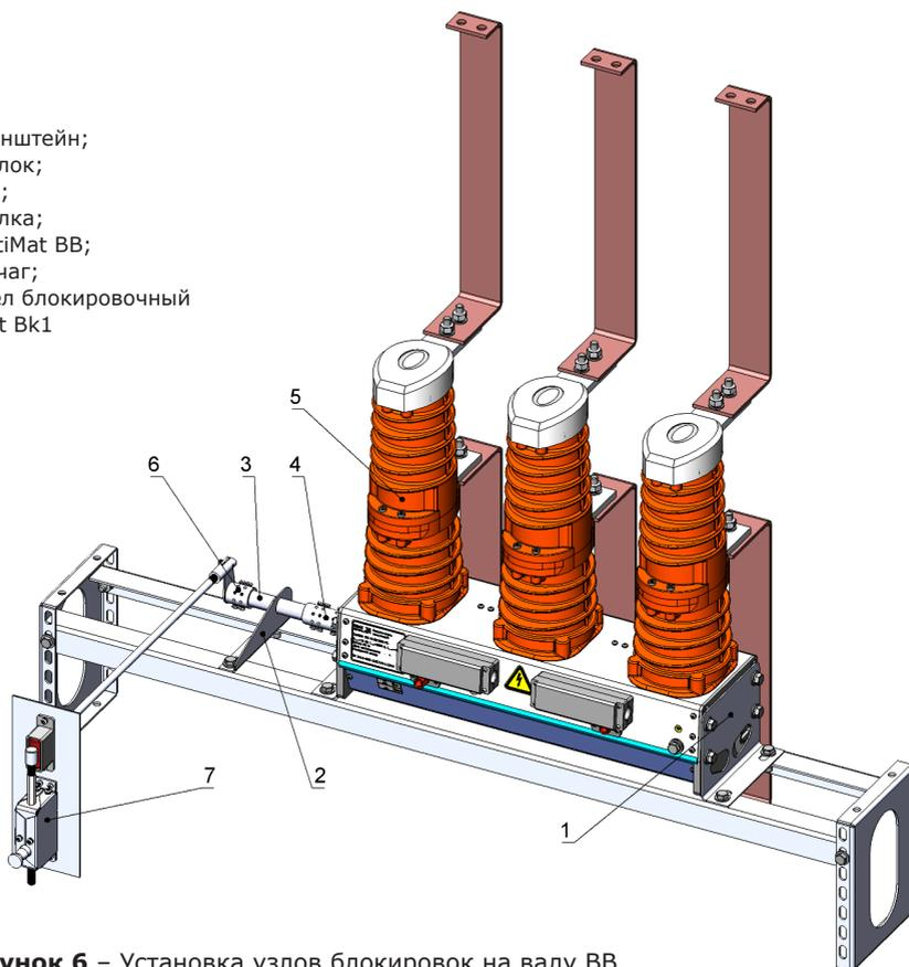
Рисунок 6 – Установка узлов блокировок на валу ВВ
