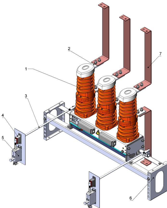
1 - OptiMat ВВ; 2 - элементы цепей главных шин; 3 - элементы тяг ручного отключения ВВ; 4 - элементы кнопок ручного отключения; 5 - узел блокировочный; 6 - рама ВВ
