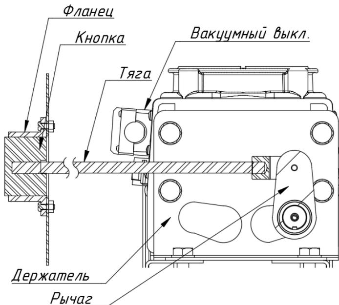
**Рисунок 7** – Схема узла ручного (аварийного) отключения
