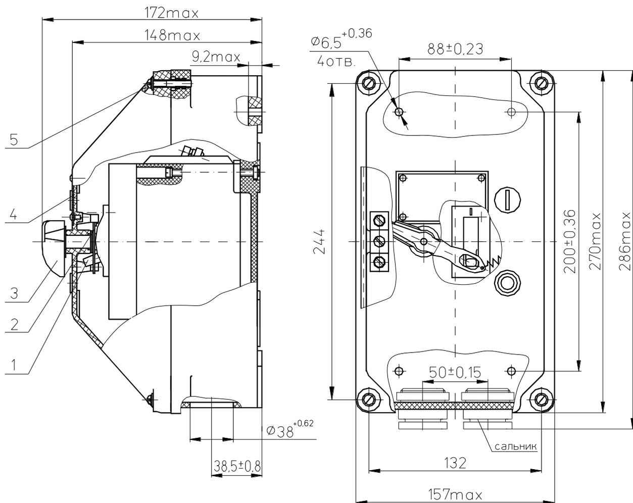
Рис. 3. Выключатель в дополнительной оболочке с сальниками
