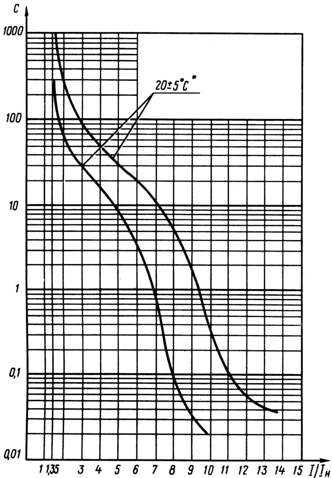
Рис.3. Выключатель переменного тока с уставкой по току 12 In,
