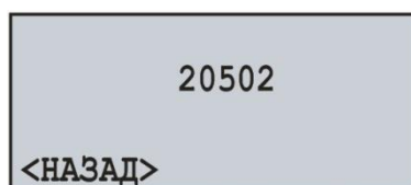
Рисунок 6.44 – Экран настройки порта подключения к серверу Overvis
