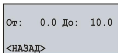
Рисунок 6.7 – Экран настройки масштаба датчика аналогового напряжения
