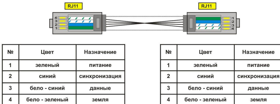
Рисунок 4.2 – Нумерация выводов кабеля КМР-11-1
