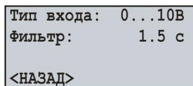
Рисунок 6.6 – Экран настройки датчика аналогового напряжения
