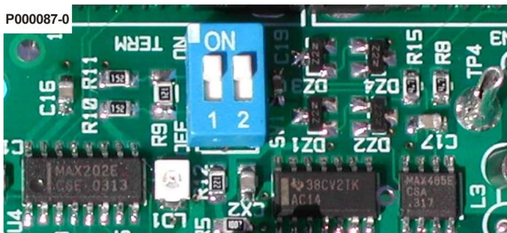
Рис. 122: Переключатели согласующего резистора интерфейса RS485
