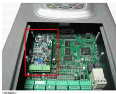
Рис. 116: Плата датчика, установленная в преобразователь
