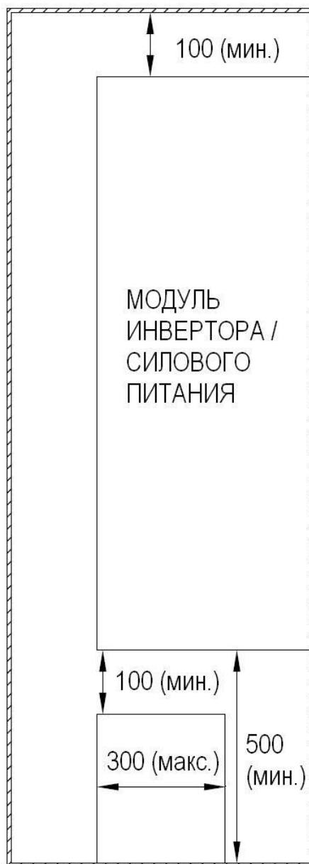
Рис. 2: Свободное пространство при установке модулей инвертора и силового питания
