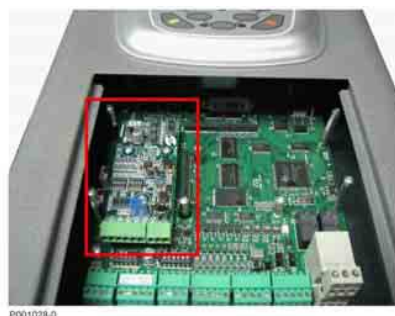
Рис. 107: Плата датчика, установленная в преобразователь
