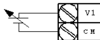
Подключение внешнего сигнала 0 ~ 10 В от контроллера
