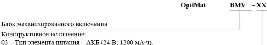
**Рисунок 1** – Структура условного обозначения БМВ
