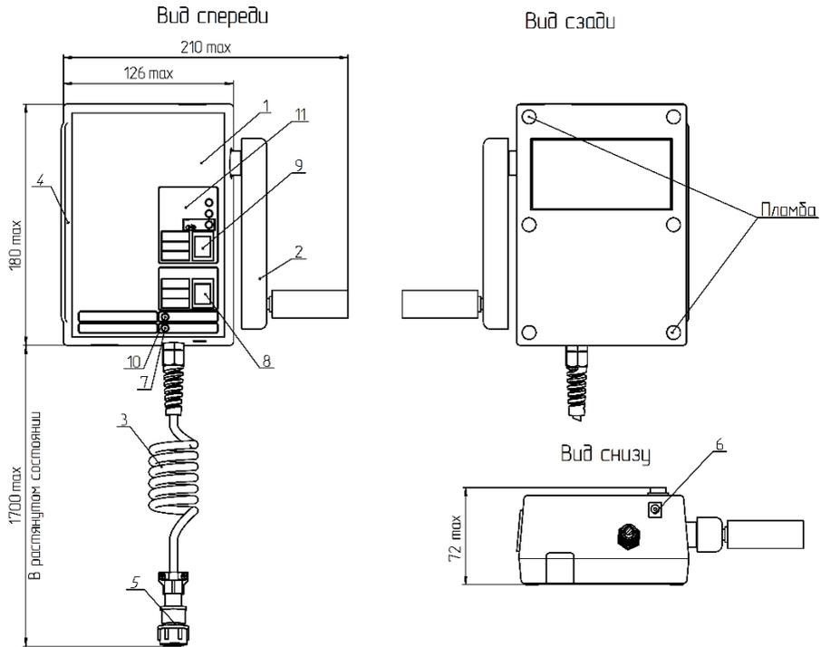
1 – Корпус; 2 – Рукоятка; 3 – Кабель подключения; 4 – Эластичный ремень; 5 – Выходная розетка; 6 – Разъем питания; 7 – Индикатор «Сетевой источник питания 12 В 1 А»; 8 – Переключатель генератора; 9 – Переключатель аккумулятора; 10 – Индикатор «Нагрузка»; 11 – Индикация уровней заряда АКБ.
