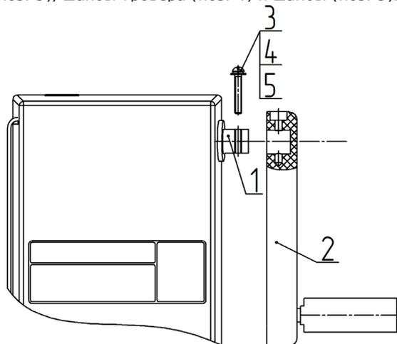
1 – Вал БМВ; 2 – Рукоятка; 3 – Винт А.М4-6gx25.58.096 (в тексте – винт);
