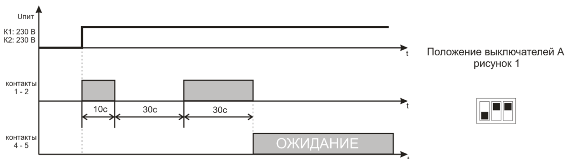
Рисунок 6 – Алгоритм работы “Реле управления (предпусковая сигнализация)”
