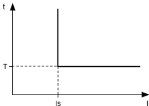
Рисунок 1.4. Принцип защиты с независимой выдержкой времени
